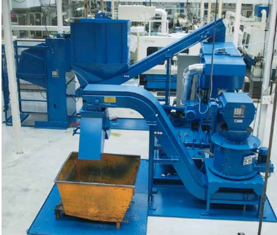
Esimerkki lastunkäsittelylaitteistosta, joka koostuu hissilaitteesta, lastunmurskaimesta, lastulingosta sekä kuljettimista.
